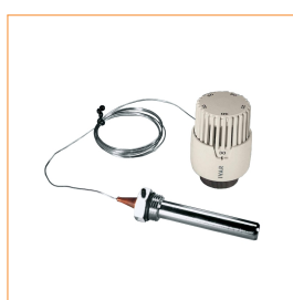
T 3011. Cap termostatat cu comanda integrata si sonda de imersie. Plaja reglaj 20÷60 °C.
